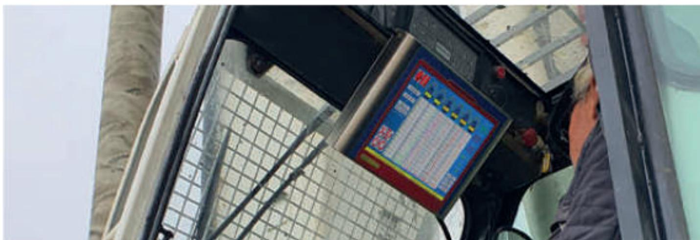
Visualización, directamente a través de la pantalla del datalogger, de los gráficos de los valores actuales y medios, en función de la profundidad y de los informes de resumen.
