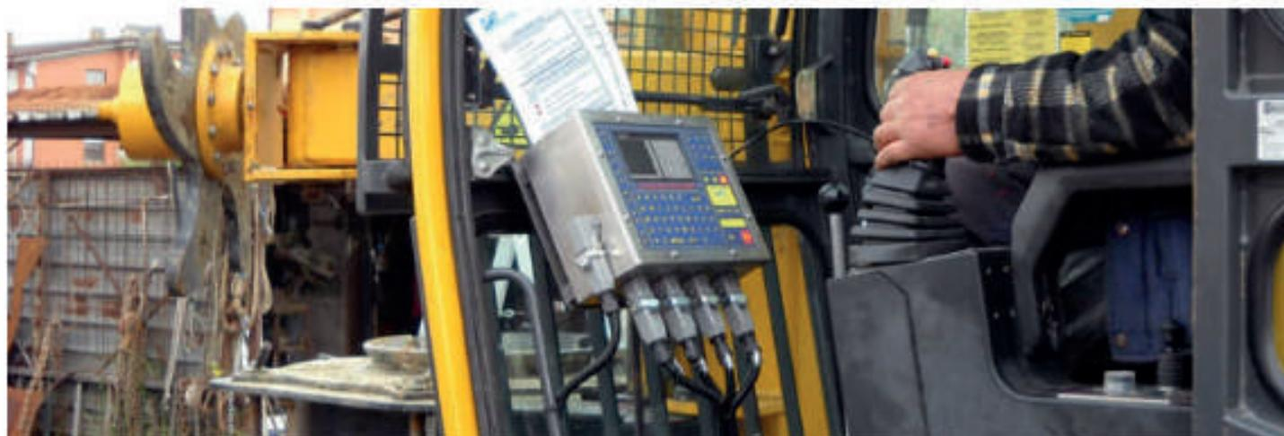
**Visualización**, directamente a través de la pantalla del datalogger, de los gráficos de los valores actuales y medios, en función de la profundidad y de los informes de resumen.
