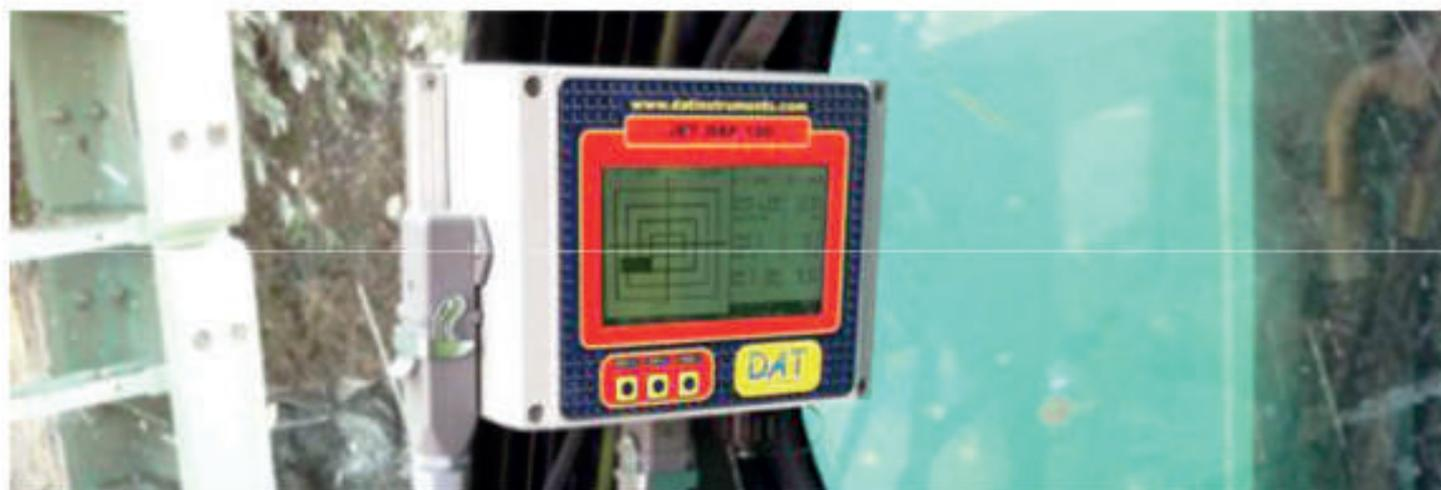
El datalogger permite visualizar en una gran pantalla retroiluminada y grabar en la memoria interna los siguientes parámetros:
