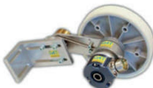
JET DEPTH2, sensor de profundidad
