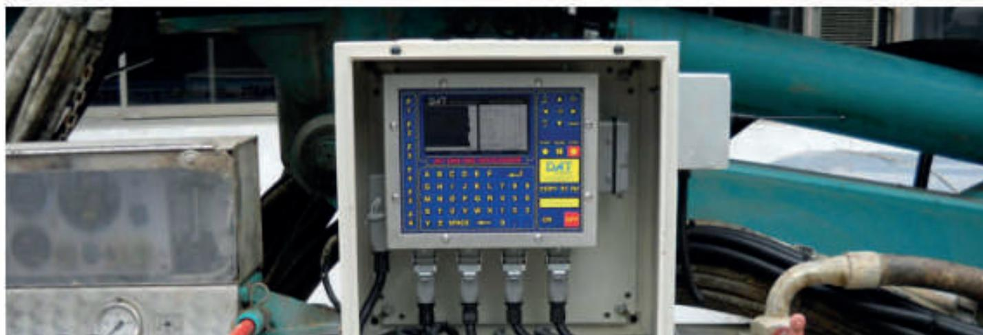
Visualización, directamente a través de la pantalla del datalogger, de los gráficos de los valores actuales y medios, en función de la profundidad y informes de resumen.
